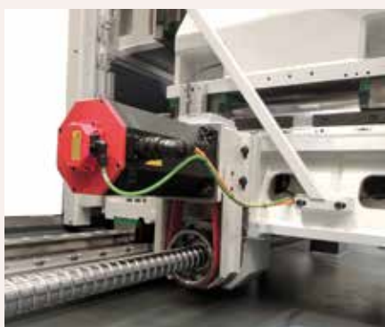
■ Motori assi in presa diretta per riduzione giochi. Direct drives of the axis to reduce the backlash.
