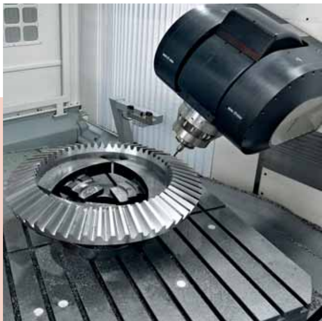
Testa a 2 assi Testa a 2 assi continui opzionale per lavorazioni particolari. 2 axes head Two continuous axes head (option) for special machining applications.
